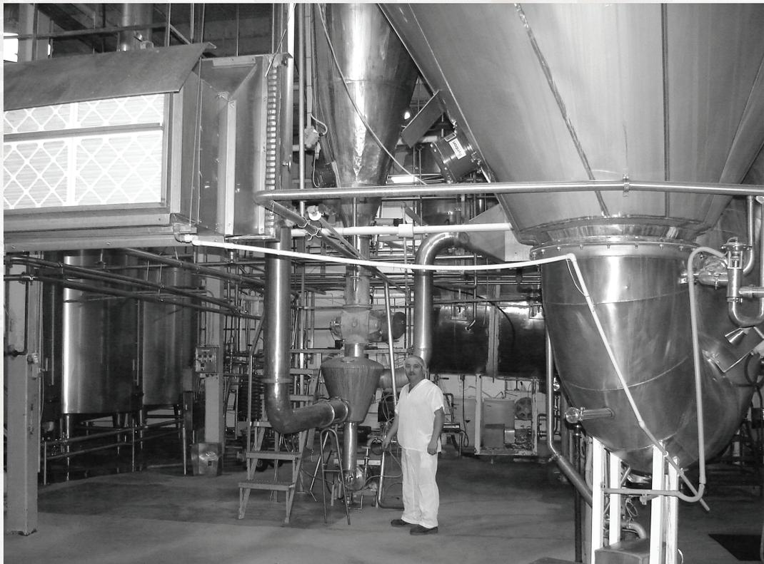
Avant d'être évaporé et séché, le lactosérum est d'abord concentré par un système de filtration par osmose inverse. L'opérateur est Camille Courchesne. (Archives d'Agrilait)
