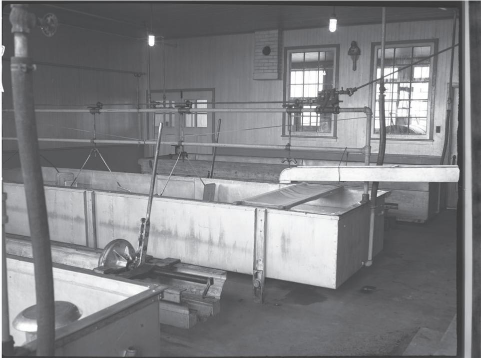
Salle de fabrication de la fromagerie montrant les bassins de fabrication et la presse horizontale pour les meules de cheddar.
